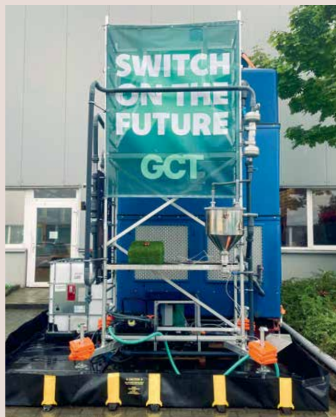
Die DAC-Demo-Anlage in Essen besitzt eine Jahreskapazität von 100 Tonnen Kohlendioxid.
